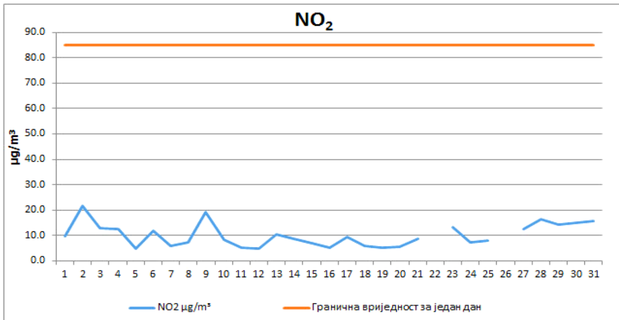
Дијаграм 3. Графички приказ просјечних имисијских дневних концентрација \text{NO}_2 за март 2017 год. у Броду (мјерно мјесто Рафинерија нафте А.Д.Брод).
